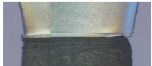
ビードなし溶着(経路制御なしの輪郭溶着)
