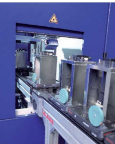
レーザー溶着機 パスルーオペレーション
