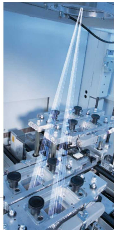
ダブルブランクの準同時レーザー溶着
