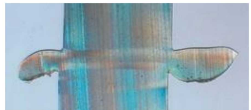
熔融溶着、成形部品の補正用(経路制御、準同時溶着)
