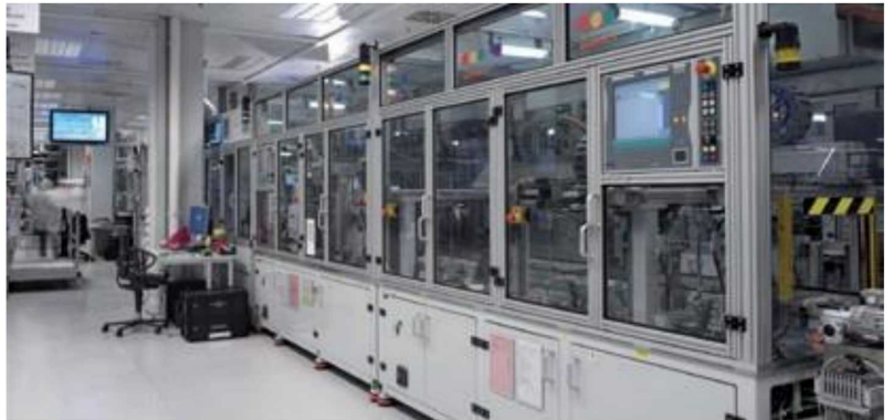
レーザー溶着技術を統合した自動生産ライン
