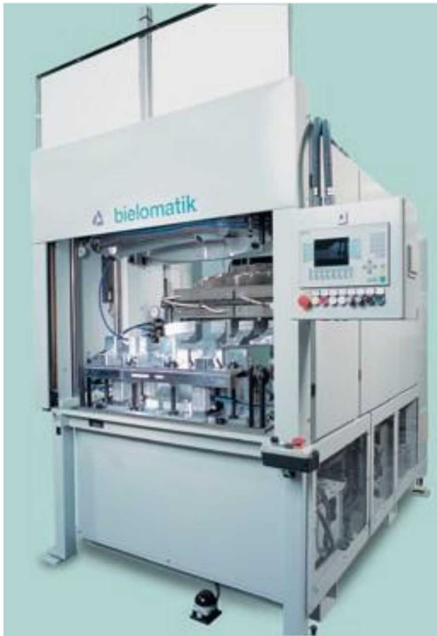
熱板溶着機K2224 非常に堅牢で通常および高温で広範囲強力溶着 クイックツール交換オプションあり
