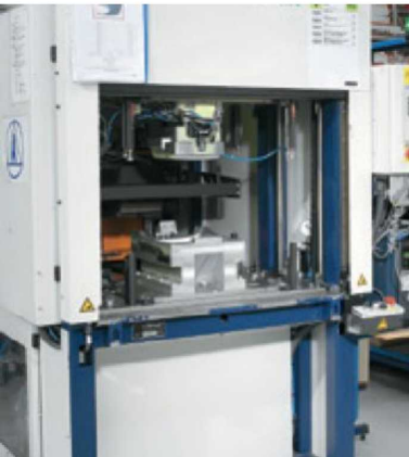
クイックツール交換機能付き 熱板溶着機 K2222は、少量生産での 柔軟な溶着作業用に特別に設計
