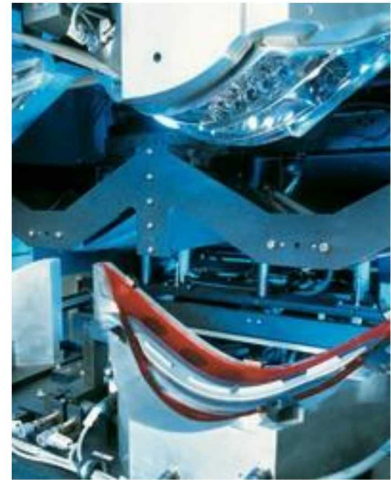
高温溶着でサイクルタイム短縮 車輦テールランプ連続生産
