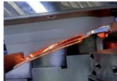
赤外線ガラス管またはフィルムラジエーターを使用した振動溶着による非接触予熱
